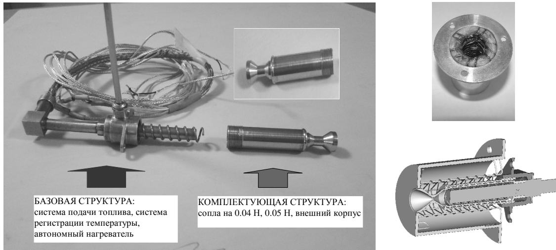
Рис. 2. Схема создания и установки в теплозащитном кожухе экспериментальных образцов ЭТМД с автономным нагревательным элементом с тягой 0,04 Н, 0,05 Н
