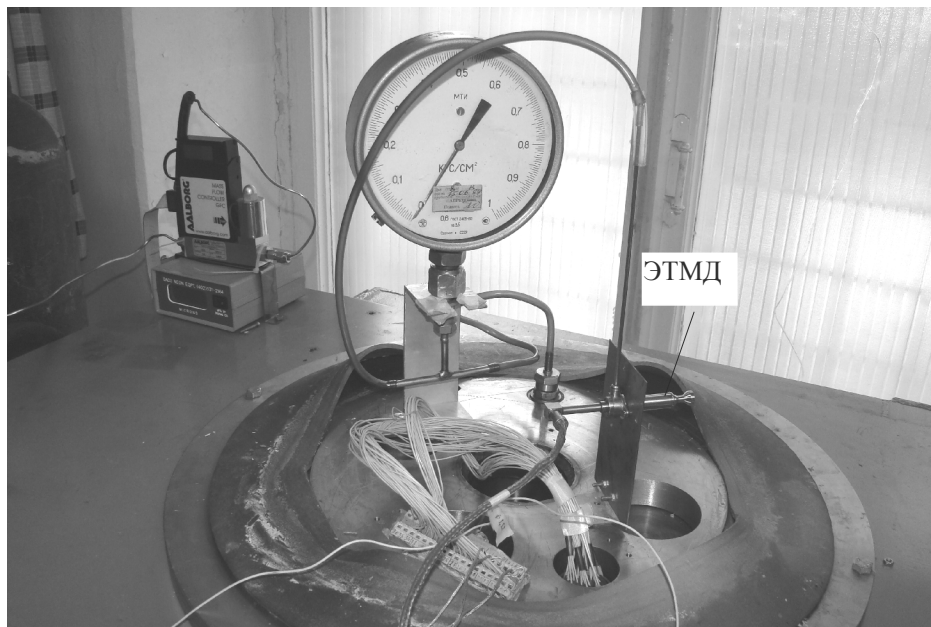
Рис. 3. Установка ЭТМД в вакуумной камере (колпак камеры и теплозащитный кожух не показаны)
