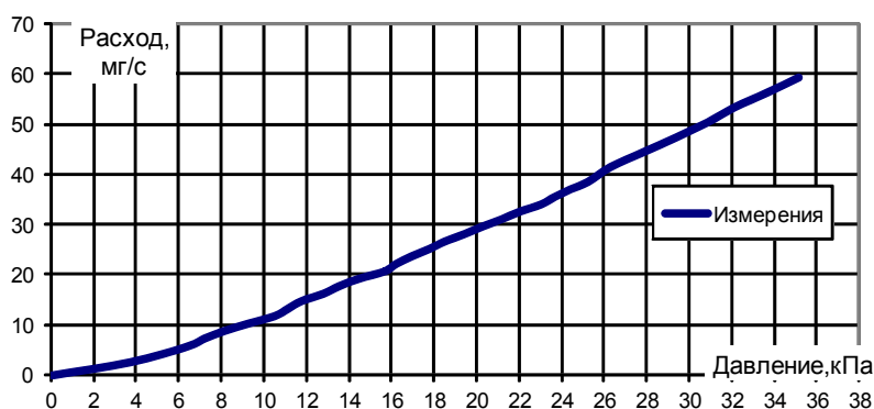
Рис. 6. Изменение расхода газа через ЭТМД с диаметром критического сечения сопла 1,52 мм
